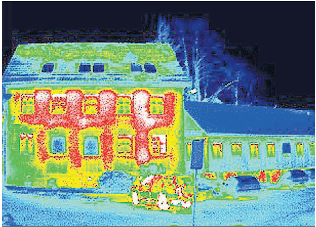
GEBÄUDEHÜLLE Die Wärmebildkamera zeigt, wo bei den Häusern viel Energie verpufft. TONI WIDMER
